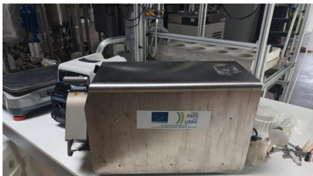
Système filtration-désinfection eau de mer/eau douce : Pompes péristaltiques de laboratoire petits et moyens débits
