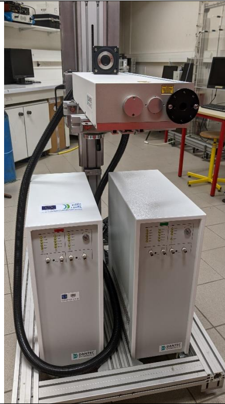
Système de visualisation hydrodynamique et système de mesure laser PIV
