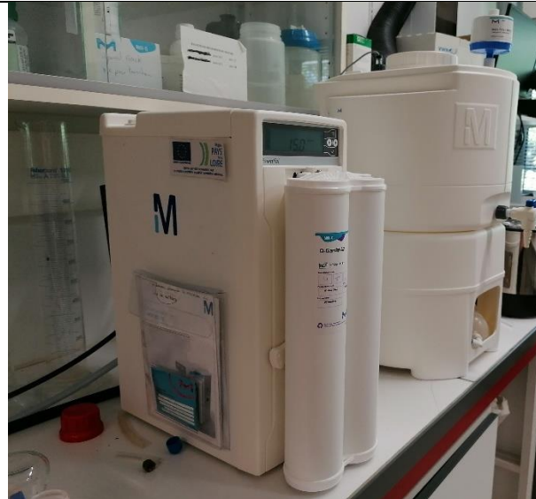
Dégazeur (production d'eau) pour granulomètre laser
