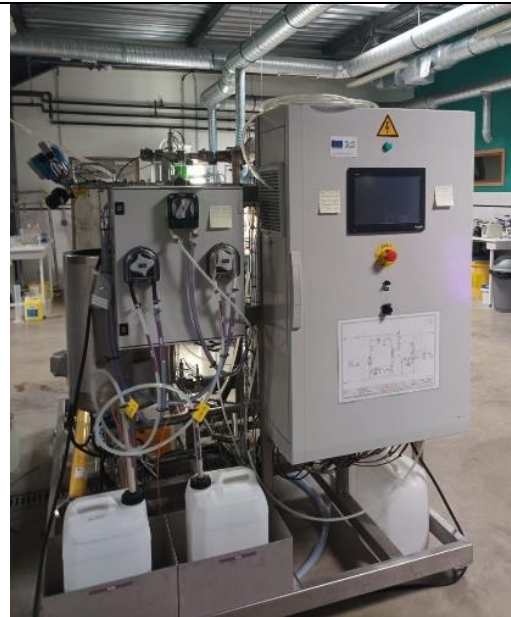
Pilote membranes filtration
