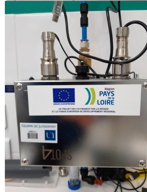
Evolution d'un photobioréacteur de pré-production (sonde CO2 + fluorimètre + spectromètre)
